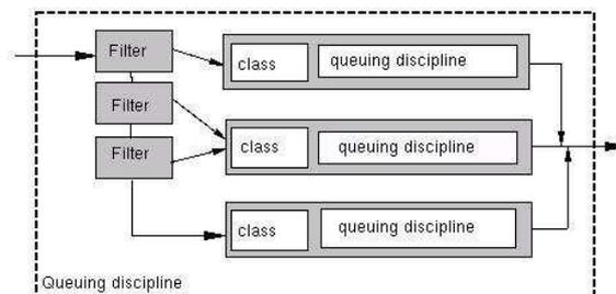
Sotto linux, il controllo del traffico è sempre stato una cosa complessa. Il comando da linea di comando **tc** ci fornisce una interfaccia per le strutture del kernel con le quali eseguire le nostre operazioni di shaping, scheduling, policing e classifying.
